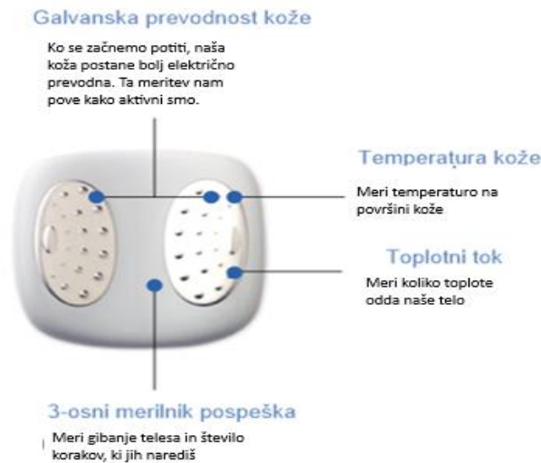
Slika 2: hrbtni del naprave s prikazom vgrajenih senzorjev
