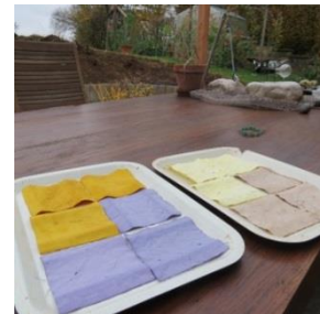
Slika 7: Izpostavitve bombažnih krpic vremenskim vplivom
