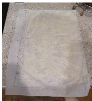
Slika 3: Tanka plast bioplastike pred izdelavo vrečke (Vir: lastni arhiv izdelkov dijakov)
